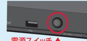
電源スイッチ ▲ 上面にある電源スイッチをONにします。
