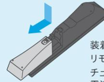
装着する電池の+の方向は、リモコン本体に記載されています。チューナーのリモコンに電池(同梱)を入れます。
